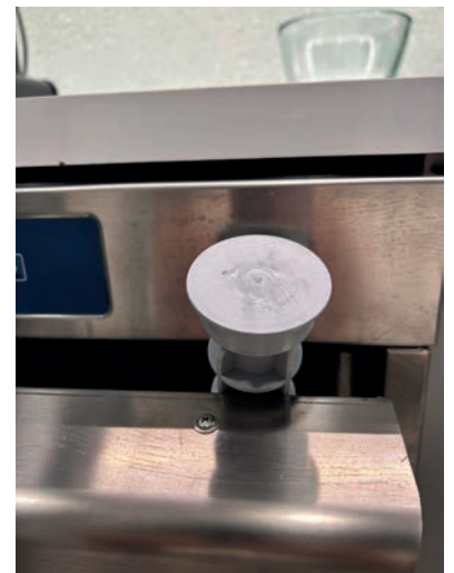
Pesukoneen alku- ja loppuasento harmaa ylivuotoputki luukun välissä
